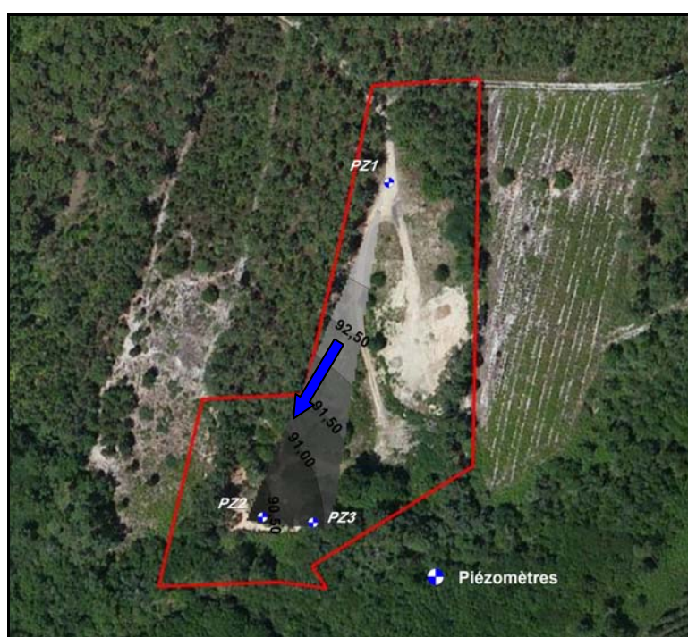
Figure 46 : Cartographie du niveau piézométrique le 07/10/2014 (13.159.RA.003.02 fig46)
